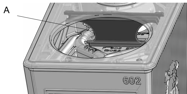
Fig. 27 Sustitución del deflector de escape
